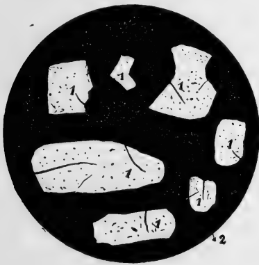
Grès pyriteux vu au microscope en lumière naturelle. 1 Quartz. 2 Pyrite. Grossissement 50 diam.
