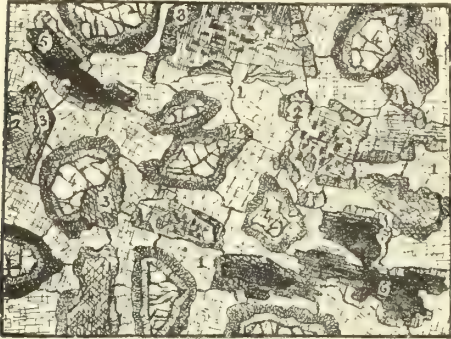
Gabbro à olivine de Pallet (Loire-Inférieure). 1, labrador; 2, diallage entouré d'amphibole brune; 3, 4, olivine entourée d'une double couronne de tremolite et d'amphibole verte; 5, fer titané entouré de biotite; 6, biotite (d'après M. Lacroix).
