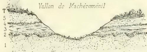
Disposition des nodules phosphatés dans le gault ardennais : 1, sables verts à A. mamillare ; 2, coquins de sables; 3, argile à H. lautus ; 4, coquins riches; 5, sables à S. inflata ; T, terre végétale.
