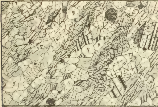
Fig. 3. — Gneiss amphibolite. (Lumière polarisée, nicols croisés; grossissement 40 diamètres.) — 1, magnétite; 2, sphène; 3, mica noir; 4, oligoclase; 5, orthose; 6, quartz; 7, quartz granitique.
