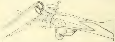
Fig. 19. — Fusil à broche avec fermeture à deux clefs.
