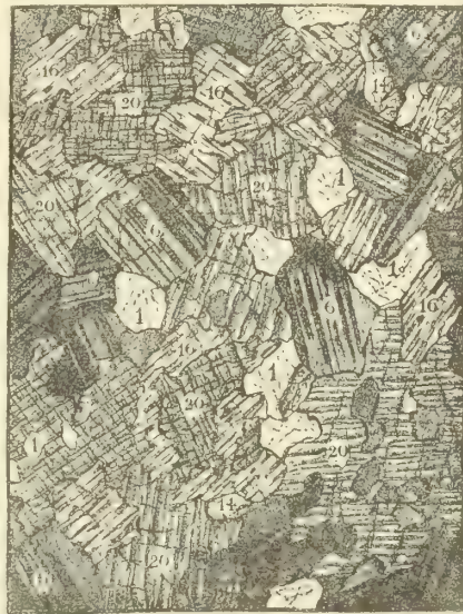
Fig. 4. — Gneiss pyroxénique à wernerite de l'Etang (d'après M. Lacroix). — 1, quartz; 6, oligoclase; 16, wernerite; 20, pyroxène.
