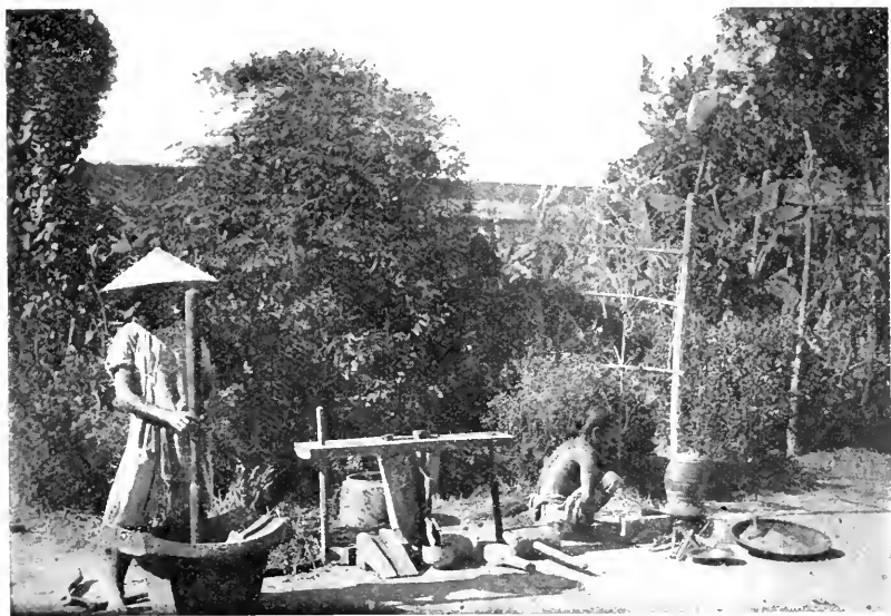
Fig. 19. — Installation annamite pour l'extraction de l'huile; les différents instruments nécessaires à cette opération sont groupés sur cette photographie.
