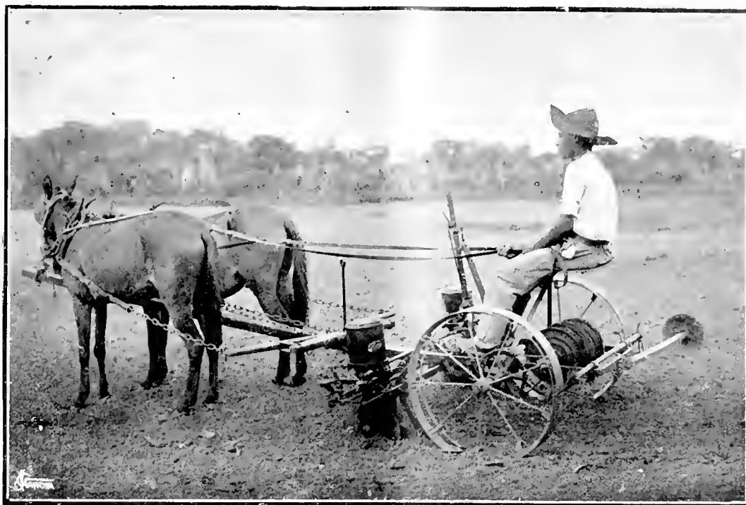
Semeador duplo, utilizado na plantação de milho
