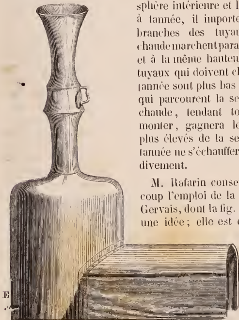
Fig. 162. — Thermosiphon de Gervais.
