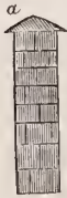
Fig. 121. — Mur d'appui à la base des montants en bois, ce qui activerait leur destruction. Si cette serre doit avoir une grande largeur, il faut établir au sommet une petite galerie pour le service des toiles et des paillassons; dans ce cas, la charpente devra être assez solide pour supporter le poids de deux hommes.
