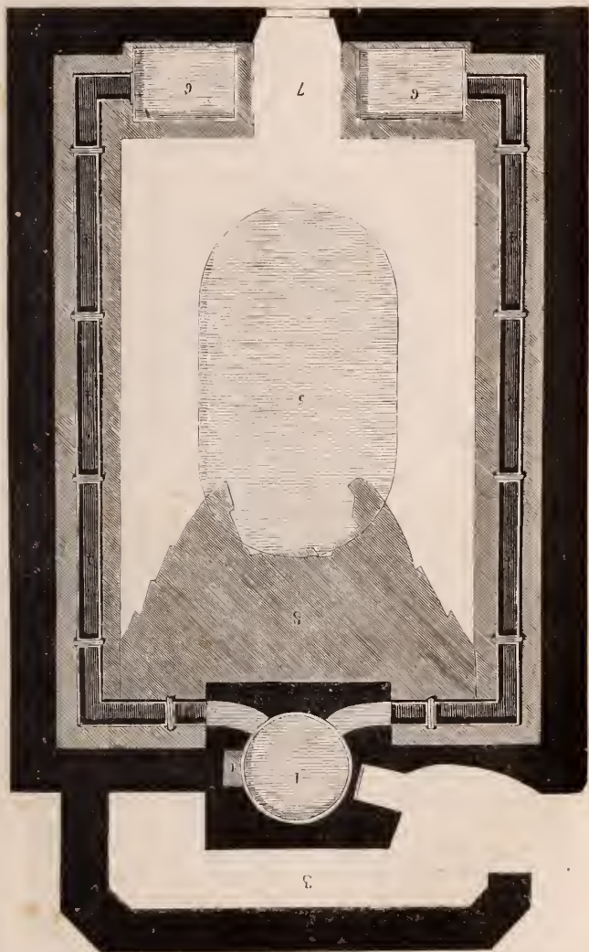
Fig. 197. — Serre Llewelyn à orchidées. (Plan et système de chauffage.)
