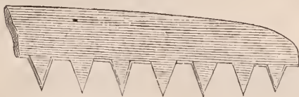
Fig. 526. — Détail de la scie à dents de brochets.
