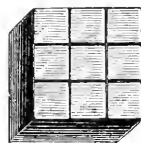
Fig. 130. Geriefte Pflasterplatten. (Eisenwerk München, A.-G., vorm. Kiess- ling u. Co.)
