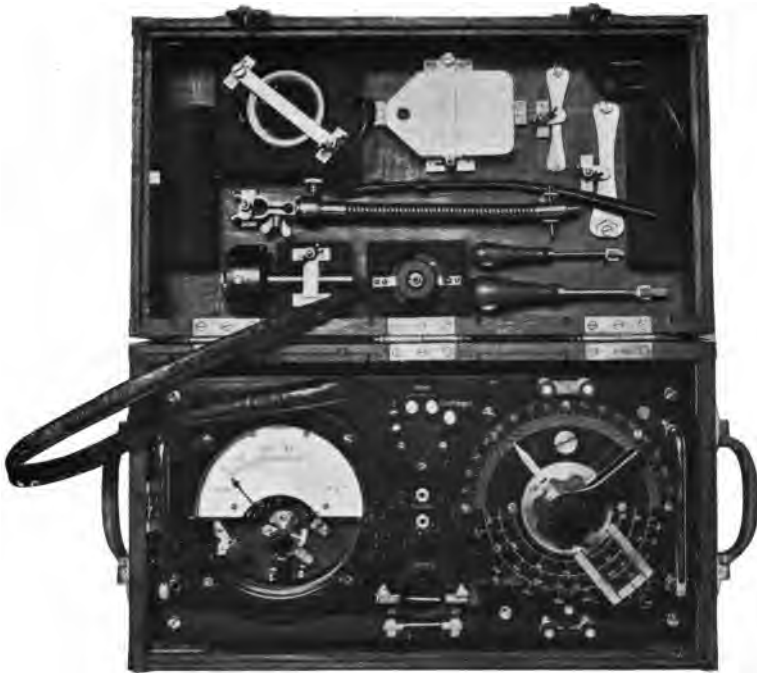
Abb. 79. Kompletter Wellenmesser der Gesellschaft für drahtlose Telegraphie in Transportkasten.
