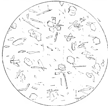
Fig. 1. — Produit obtenu par la fusion d'un mélange de fluorure d'aluminium, de silice et de potasse ; matière vitreuse renfermant des cristaux aciculaires, de sillimanite et de tables hexagonales de tridymite. — Grossissement de 200 diamètres.
