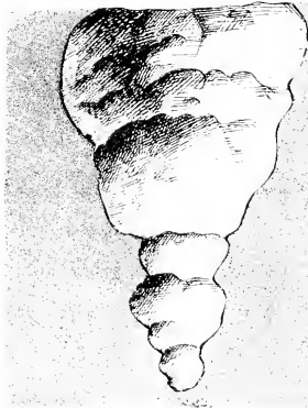
Fig. 4. — Forme des perforations obtenues au travers d'un bloc de calcaire grossier par un jet descendant d'eau acidulée.
