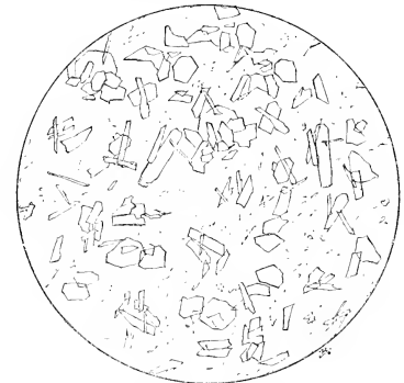
Fig. 2. — Produit obtenu par la fusion du mélange de fluorure d'aluminium, de silice et de chaux ; matière vitreuse renfermant des cristaux aciculaires de sillimanite et de tables hexagonales de tridymite. — Grossissement de 200 diamètres.
