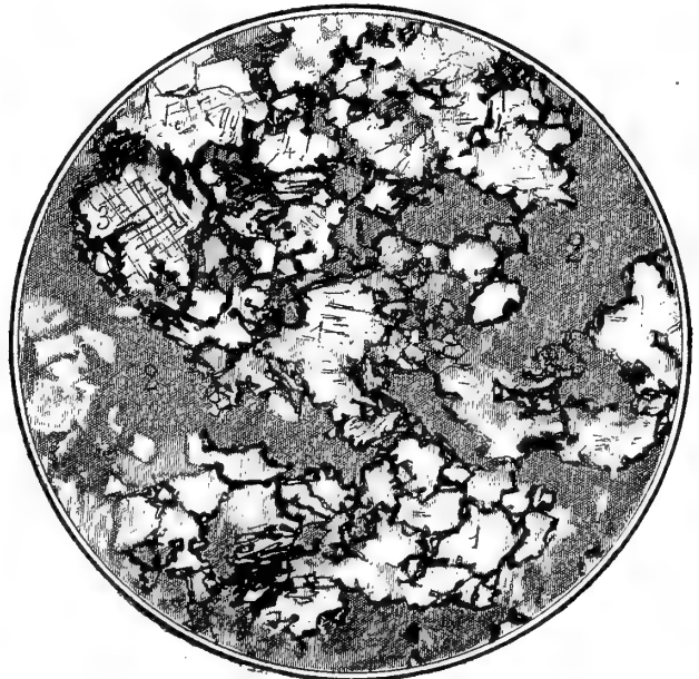
Fig. 4. — Granulite à grains fins constituant un monticule au sud de Yabanda. — 1. Quartz. — 2. Orthose. — 3. Microcline. — 4. Plagioclases. — 5. Inclusions opaques.
