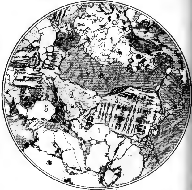
Fig. 6. — Gneiss au sommet du Pic Crampel, vu dans la lumière polarisée. — 1. Quartz en grains arrondis. — 2. Orthose. — 3. Microcline. — 4. Mica noir. — 5. Fer oxydulé.
