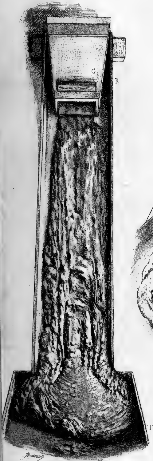
Fig. 1. — Appareil destiné à l'imitation artificielle des épanchements boueux. — C, réservoir de la boue. R, glissière inclinée à 64°. T, table inclinée à 5 degrés — 1/10 de la grandeur naturelle.
