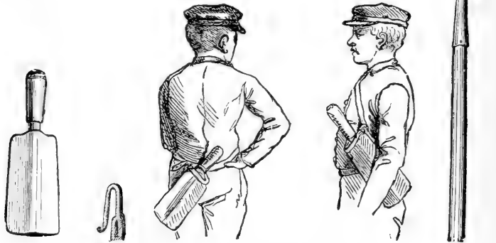
Fig. 360. — SERPE d'élagage renforcée, longueur 40 centimètres. — Fig. 361. — CROCHET porte-serpe. — Fig. 362. SERPE en ceinturon. — Fig. 363. SERPE en bandoulière. — Fig. 364. ÉMONDOIR pour enlever les petites branches gourmandes.
