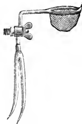
Fig. 71. Filet à crochet bi dent de M. Paul Petit, se vissant au bout d'une canne.
