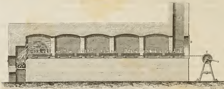
Fig. 40. — Four à recuire à feu continu.
