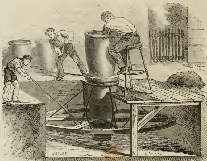
Fig. 255. — Tournette du potier, ou roue à modeler les pièces de grande dimension.
