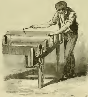
Fig. 27. — Ouvrier fendant le manchon.
