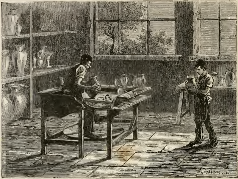
Fig. 24. — Tour du potier. — Tournassage des poteries.
