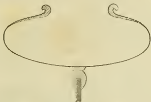
Fig. 35. — Quatrième forme de la paraison retournée et fixée au pontil.
