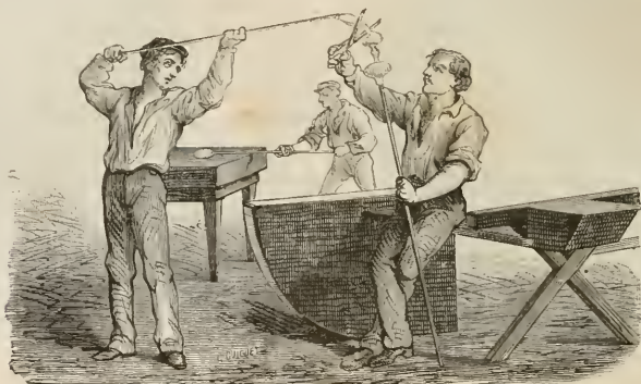
Fig. 18. — Pose de la matière du pied du verre.
