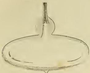
Fig. 34. — Troisième forme de la paraison.
