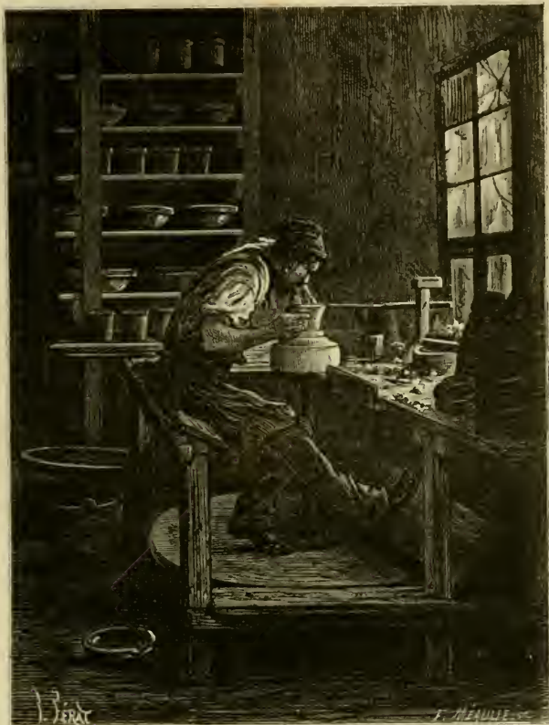
Fig. 256. — Ébauchage d'un pot à fleurs.
