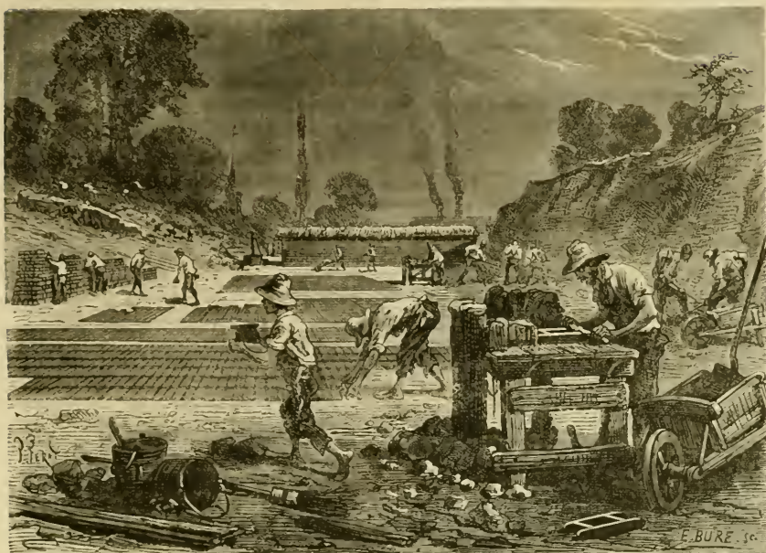
Fig. 252. — Moulage des briques.
