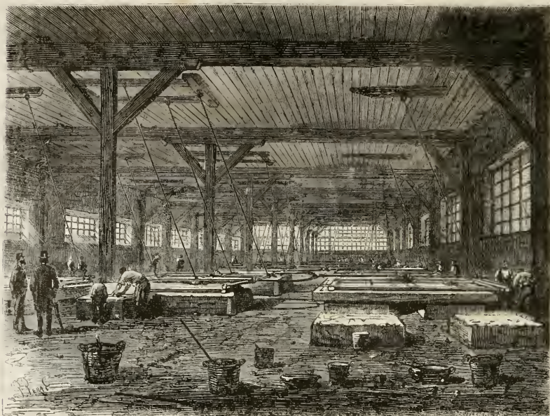
Fig. 51. — Opération du doucissage des glaces
