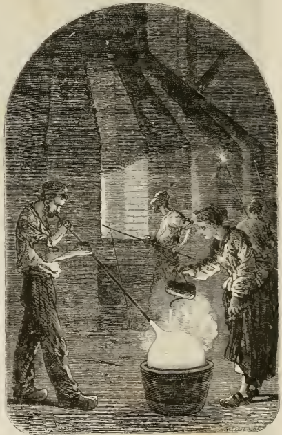
Fig. 43. — Soufflage d'une bonbonne.
