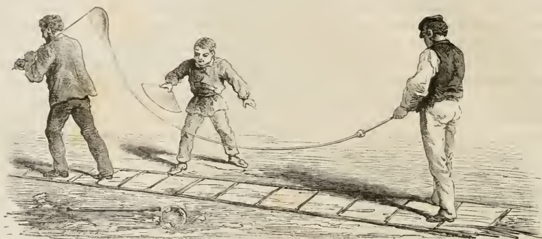
Fig. 45. — Étirage d'un tube. Le gamu refroidit à l'aide d'un éventail les parties du tube qui s'amincissent trop vite.
