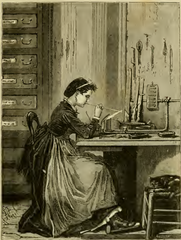
Fig. 97. — Ouvrière parisienne soufflant une fausse perle.
