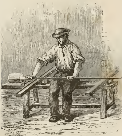
Fig. 81. — Fabrication d'une carafe. Le verrier assis sur son banc.
