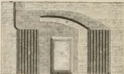
Fig. 408. — Four à pyrites de Marseille (coupe et plan).
