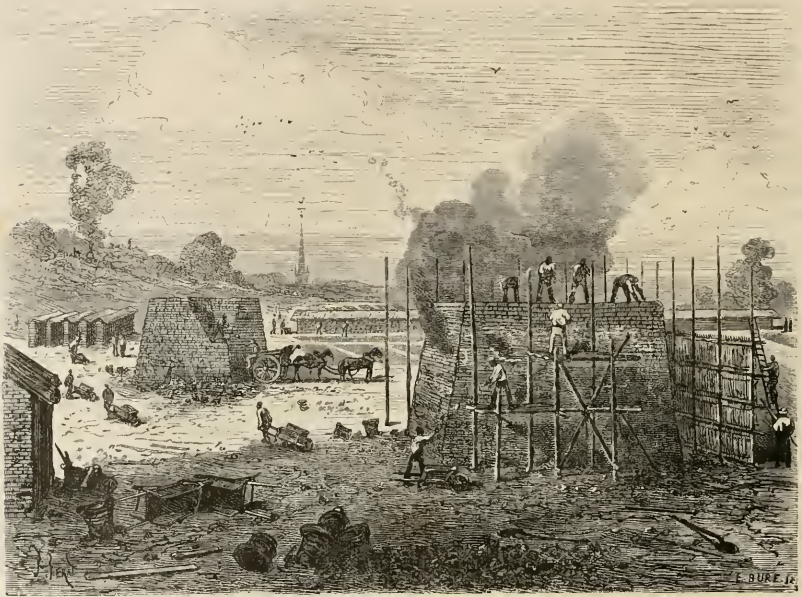
Fig. 253. — Cuisson des briques en plein air.
