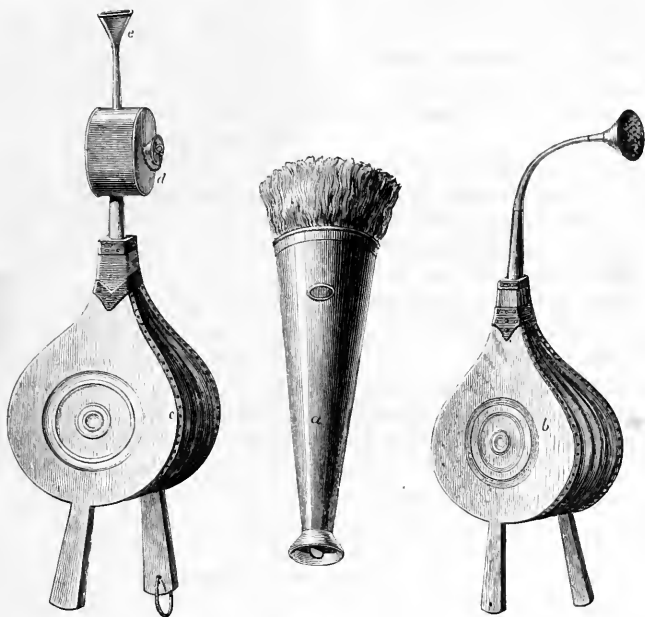
Fig. 399, 400 et 401. — Soufflets et houpe pour répandre les fleurs de soufre sur la vigne et les arbres fruitiers.
