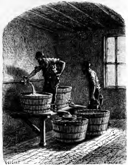
Fig. 265. — Lavage du kaolin, pour en séparer par décantation les grains de feldspath.
