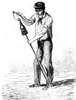
Fig. 39. — Façonnage du goulot de la bouteille.
