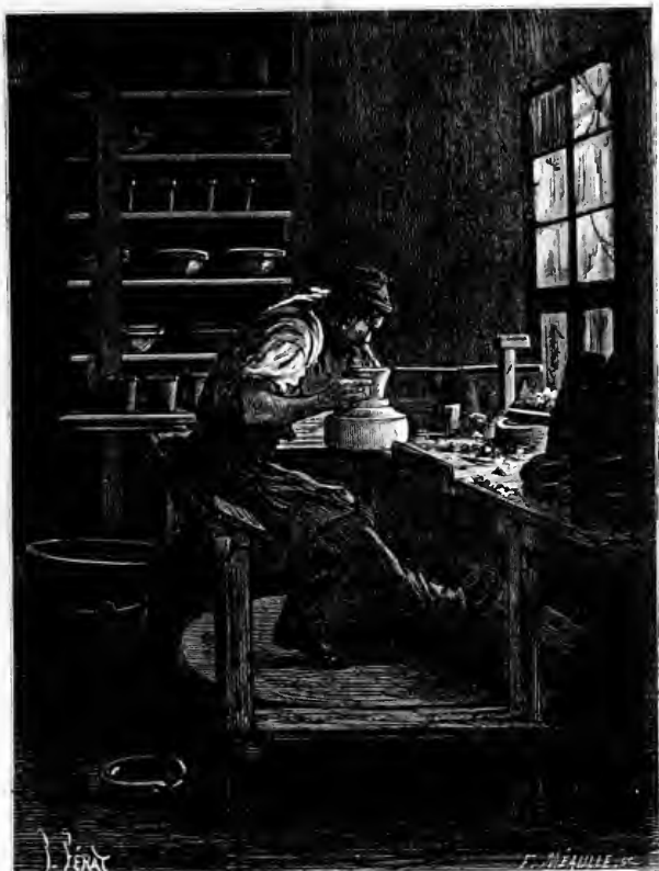
Fig. 256. — Ébauchage d'un pot à fleurs.
