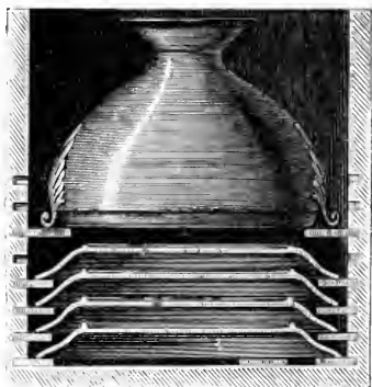
Fig. 260. — Cazette pour l'enfournage des pièces de faïence vernissées.
