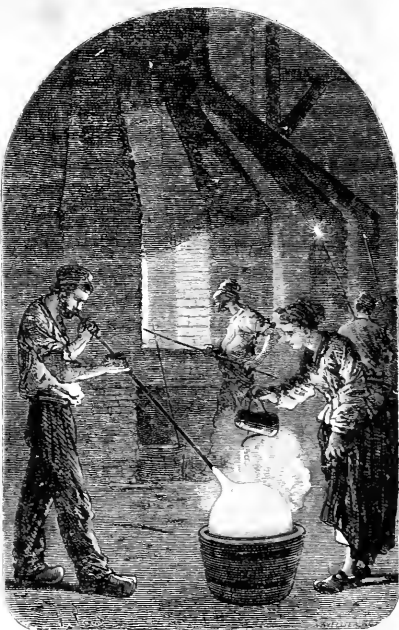
Fig. 43. — Soufflage d'une bonbonne.
