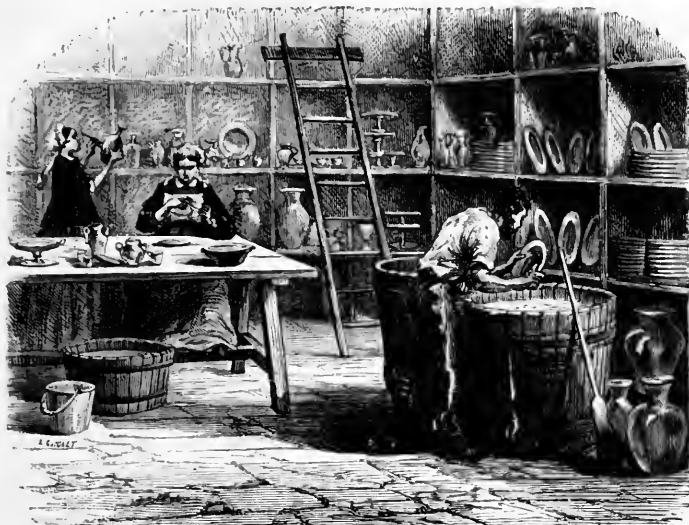
Fig. 261. — Dépôt du vernis sur la faïence par immersion et retouche des pièces couvertes de poudre de vernis, pour enlever le vernis sur les points de support.
