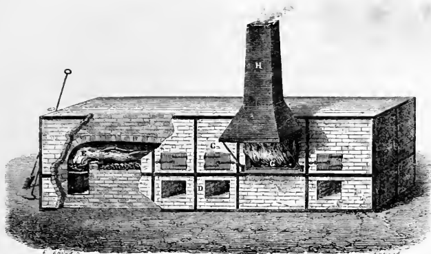
Fig. 340. — Fourneau pour la transformation du salin en potasse.
