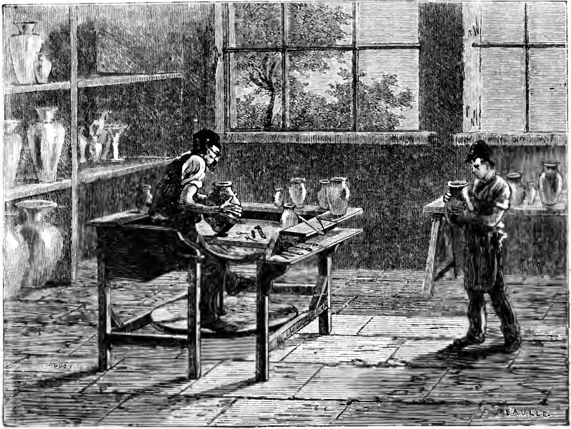
Fig. 24. — Tour du potier. — Tournassage des poteries.
