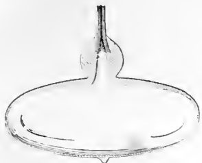
Fig. 31. — Troisième forme de la paraison.
