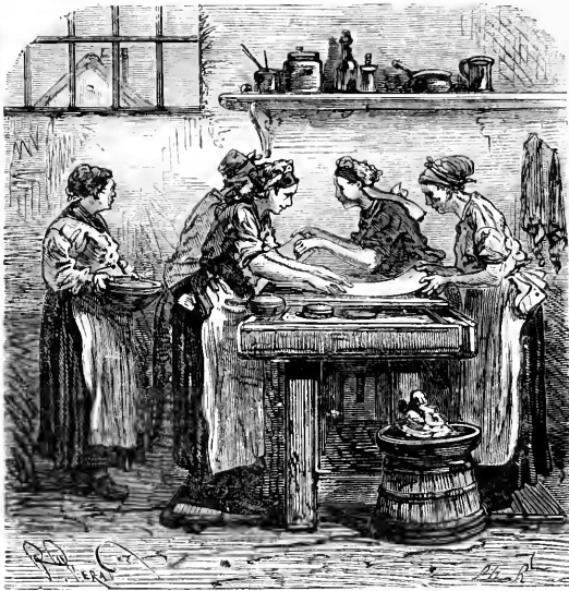
Fig. 52. — Argenture d'une glace par le procédé Drayton.
