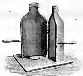
Fig. 70. — Moule d'un flacon de cristal.
