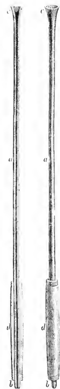
Fig. 21, 22. Canne du verrier, d, manche; b, embou- chure; a, corps de tube; c, extrémité ou nez.
