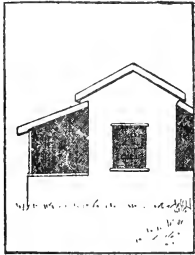
Fig. 56. — Habitation avec véranda, fenêtres et portes, clôturées par de la toile métallique, pour empêcher la pénétration des moustiques. (Cliché de la South african anti-malarial Association.)
