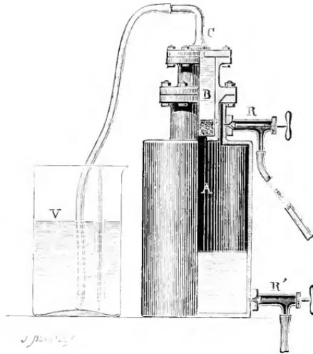
Appareil de MM. Miquel et Benoist pour stériliser à froid les liquides putrescibles avec le secours du vide et des hautes pressions, figuré au  $\frac{1}{4}$  de grandeur.
