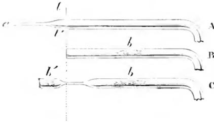
la portion terminale du tube contenant la bouffe *b'*. Cette manœuvre préliminaire est donc uniquement destinée à munir la branche effilée en pointe du tube à boule d'une bouffe filtrante absolument privée de germes : elle peut être accomplie à l'avance par le préparateur
