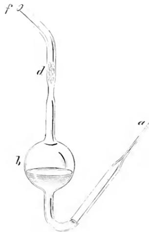
Tube à boule disposé pour la culture des microbes, au  $\frac{1}{2}$  de grandeur.
