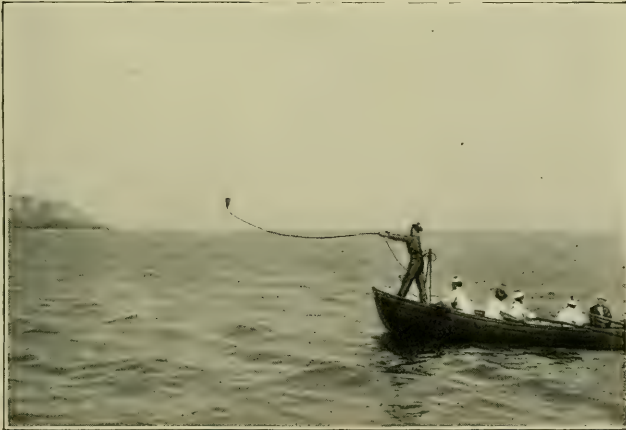
SONDAGES A LA MAIN, PAR PETITES PROFONDEURS
