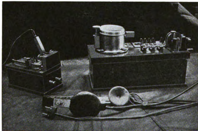
Abb. 8. Empfänger mit Fritter- u. Schloemilchzelle.
