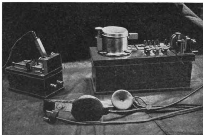
Abb. 8. Empfänger mit Fritter- u. Schloemilchzelle.
