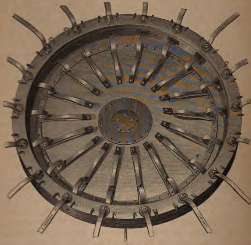
Das Ventil des „Nordpol“.
