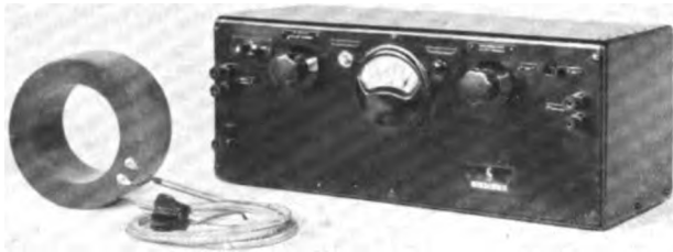
Abb. 14. Schweißstromprüfer und -überwacher zur Einstellung, Prüfung und Überwachung des Sekundär-Schweißstromes
