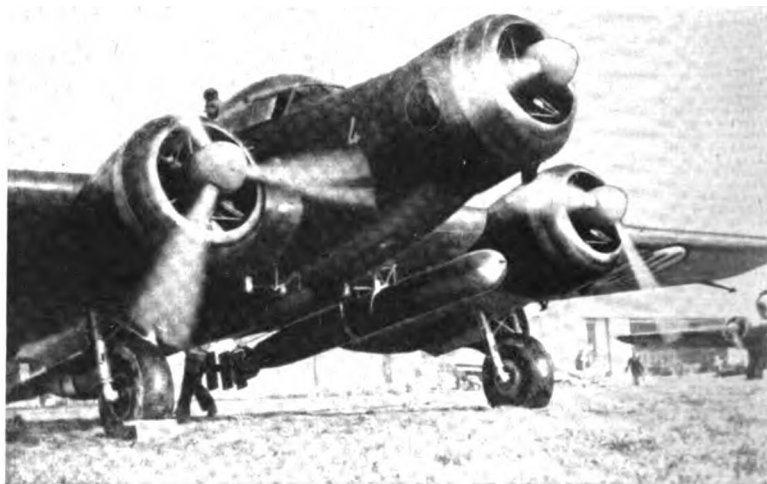
Abb. 10. Italienisches Kampfflugzeug mit am Rumpf befestigtem Lufttorpedo
