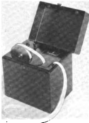
Abb. 15 (oben). Schweißzeitprüfer zur Feststellung der Periodenzahl des Schweißstromes für Punkt- und Nahtschweißbetrieb
