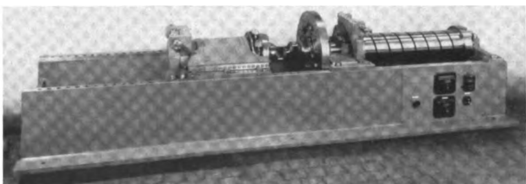
Abb. 9. 2000 mkg-Torsator mit einem Kurbelwellenabschnitt als Probe
