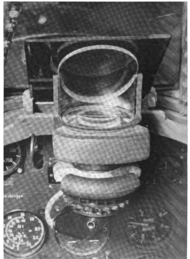
Abb. 7. Reflexvisier mit hochgeschobener Blendscheibe bei der Supermarine „Spitfire“
