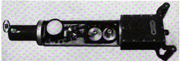
Abb. 4 und 5 (oben). Messter-Zielübungsgerät BF. Seitenansicht bei geschlossenem Zustand und Aufsicht auf das geöffnete Instrument (1/6 nat. Größe)
