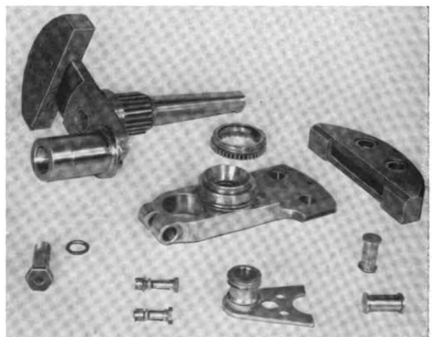
Abb. 8. Kurbelwelle mit Drehschwingungsdämpfer nach Sarazine-Taylor des Wright-„Cyclone“ GR-1820-G 102 A
