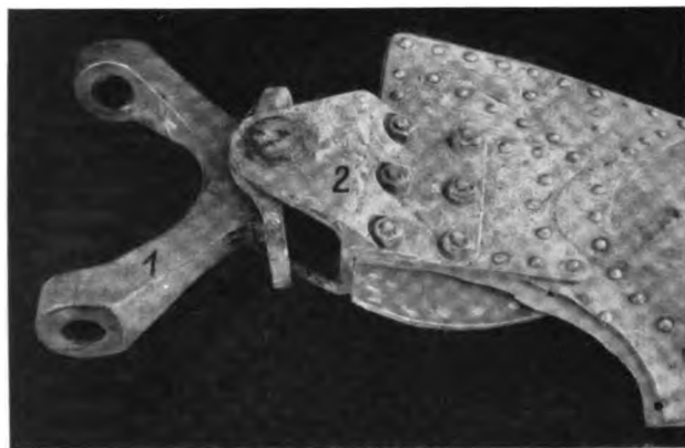
Abb. 3. Flügelanschluß der Vickers „Wellington“
