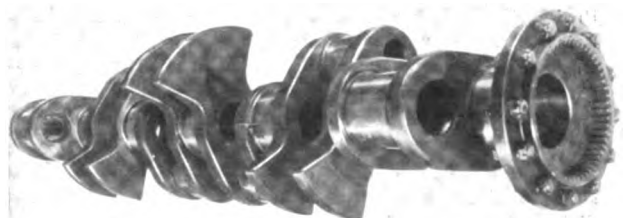
Abb. 1. Kurbelwelle des Rolls-Royce „Merlin“ X
