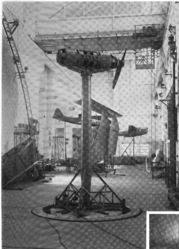
Abb. 9. Versuchsaufbau für Luftschraubenuntersuchungen bei Schräganblasung. Antriebsmotoren ohne Verkleidung
