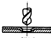
Bild 15 Aufbohren der Bleche auf Nennmaß
