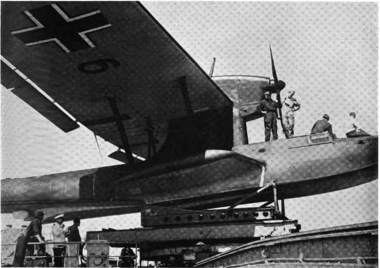
Die Vorbereitungen für den Abschluß des Flugzeuges sind beendet. Das Flugboot ruht auf einem Schlitten, der es in einer Zeitspanne, die nur Sekundenbruchteile beträgt, über die Schleuderbahn ziehen wird
