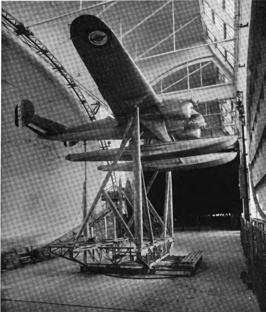
Abb. 4. Versuchsaufbau eines Schwimmerflugzeuges „Hydravion Gourdou Hy 120“. Modell 1:4.
