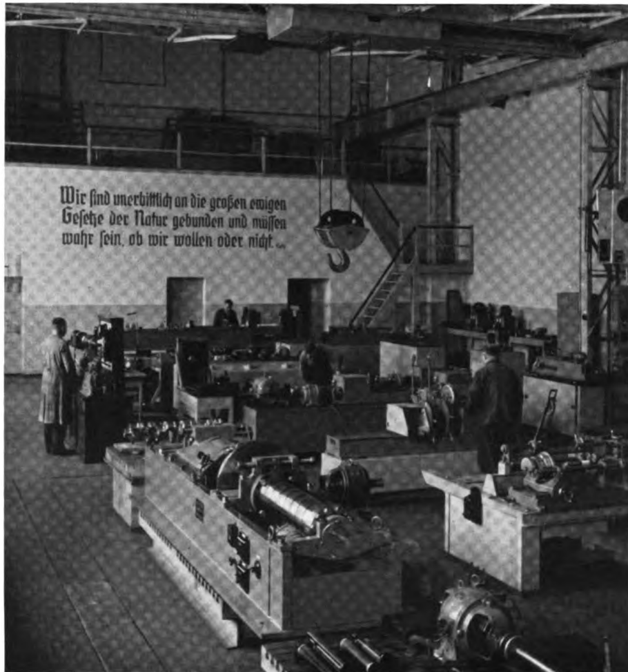
Prüffeld für Schwingprüfmaschinen
