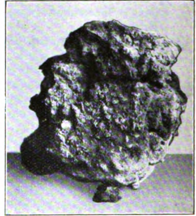
Nr. 40. Abb. b. — \frac{1}{5} . Schlackenkuchen eines Eisenschmelzofens kleinen Typs von oben.
