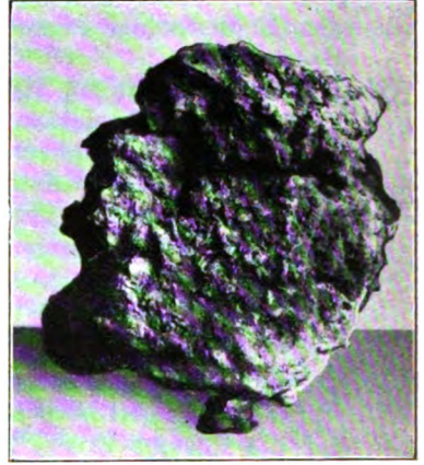
Nr. 40. Abb. b. — \frac{1}{12} . Schlackenkuchen eines Eisenschmelzofens kleinen Typs von oben.
