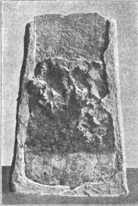
Nr. 40. Abb. a. Eisenschmelzofen von kleinem Typus, senkrecht durchschnitten, in Gips. — etwa \frac{1}{10} .
