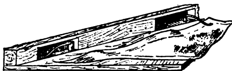
Fig. 29. Section de tiroir du meuble précédent pour montrer les ressorts placés sous les rebords et destinés à maintenir rigides les planches en feuilles.
