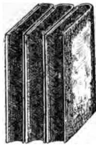
Fig. 59. Apparence extérieure des livres qui ont souffert d'une chaleur intense et continue; la partie noire des plats et des tranches est la partie carbonisée.
