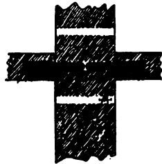
Fig. 17. Coupe d'un montant et de deux tablettes pour montrer la position des clavettes.
