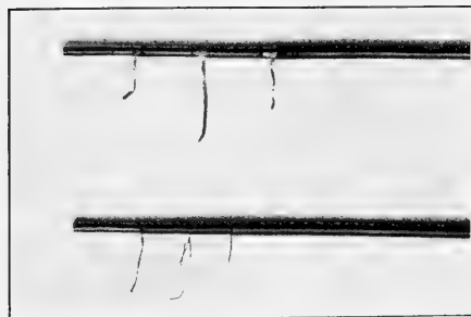
Abb. 14. Kupferleiter mit Eisendrahtumspinnung.
