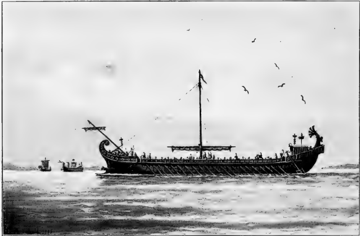
Abbildung 2. Römische Liburne um 50 n. Chr., nach Arenhold. Länge 30 m, Breite 4 bis 5 m, Tiefgang 1,25 m, Gewicht 80 t. 120 Mann, darunter 84 Ruderer auf 14 Ruderbänken, 42 Riemen jederseits, je 3 Riemen von 1 Bank aus zu bewegen, 1 großes Segel und 1 kleines Segel nur für den Marsch. (Original im Museum für Meereskunde.)
