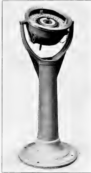
Abbildung 14. Tochterkompaß der Übertragung.
