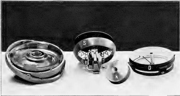
Abbildung 8. Hauptteile des Anschützchen Kreiselkompasses.
