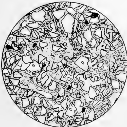
Dunite massive serpentinisée. Coupe n° 706. Lumière naturelle. Grossissement = 22 diam. La coupe montre des noyaux d'olivine disséminés dans la masse serpentineuse due à l'antigorite.
