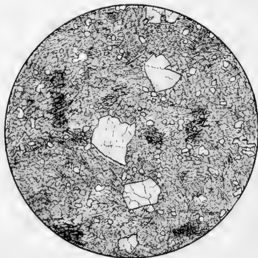
Type porphyrique à augite (basaltite). Coupe n° 702. Lumière naturelle, la masse est dessinée en lumière polarisée. Grossissement = 22 diam. La coupe montre les phéno-cristaux d'augite disséminés dans la base décomposée qui représente la pâte.
