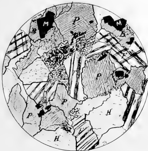
Norite à micropegmatites. Coupe n° 1084. Lumière naturelle, les feldspaths en lumière polarisée. Grossissement = 22. P = pyroxène. M = magnétite. B = biotite. H = hypersthène. Micropegmatites d'hypersthène et de feldspath puis d'hypersthène et de magnétite.
