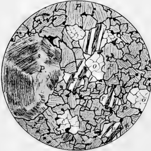
Tilaïte porphyroïde. Coupe n° 166. Lumière naturelle, les feldspaths sont dessinés en lumière polarisée. Grossissement = 13 diam. P = pyroxène. O = olivine. F = feldspath.
