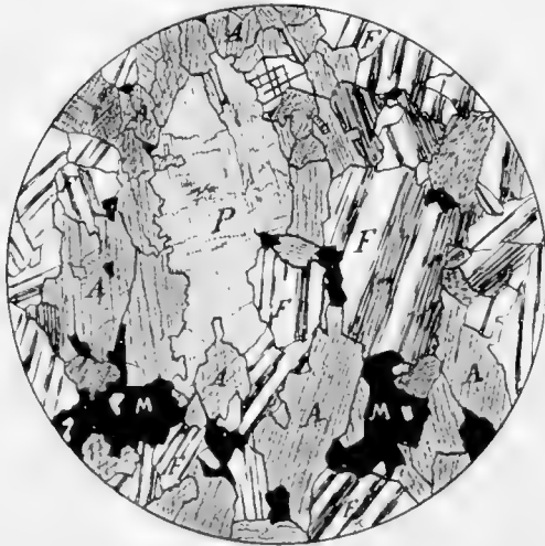
Gabbro ouralitisé. Coupe n° 1090. Lumière naturelle, les feldspaths en lumière polarisée. Grossissement = 22 diam. P = pyroxène. A = amphibole. M = magnétite. F = feldspath.
