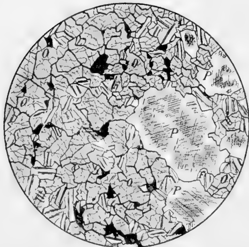
Garéwaïte de Garéwaïa. Coupe n° 168. Lumière naturelle, les feldspaths kaolinisés ont été reconstitués et supposés dessinés en lumière polarisée. P : pyroxène. O = olivine. F = feldspaths. Les grains opaques sont de la chromite.
