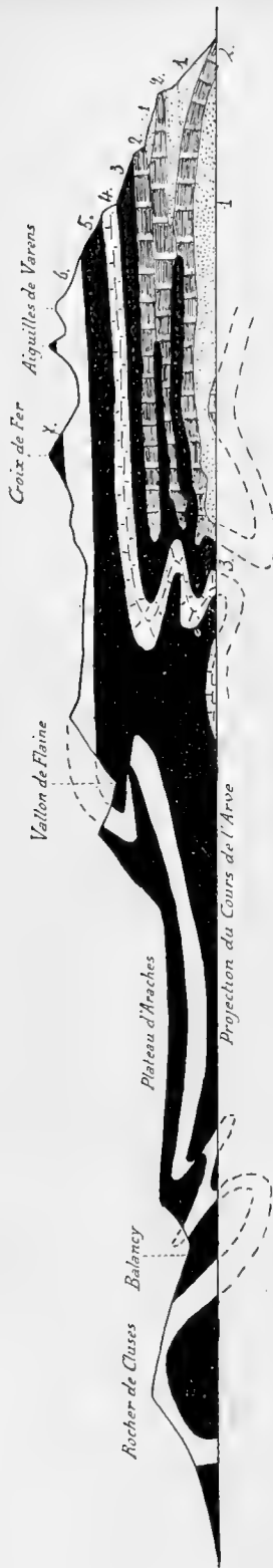
Fig. 27. — Profil de la rive droite de l'Arve, entre Cluses et les Aiguilles de Varens, montrant les discordances de plissement. (D'après Ritter.) 1. Lias. — 2. Dogger. — 3. Oxfordien. — 4. Malm. — 5. Néocomien. — 6. Urgonien. — 7. Crétacé moyen et supérieur, Tertiaire.
