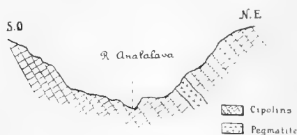
Fig. n° 13. Profil du filon de la taille n° 13.
