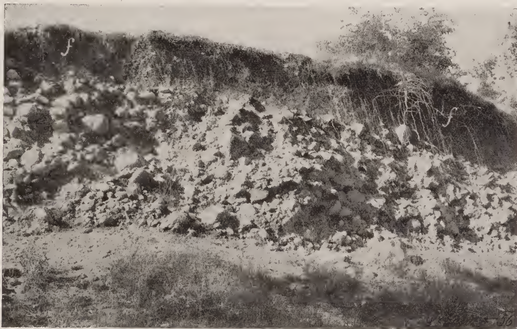
Fig. 2. — Morena Mindel I della piccola cava abbandonata sopra lo stradone per Porto-Portese, 50 metri prima del bivio, sopra il cancello della Villa Portesina (Camping): alta sei metri e ricca di ciottoloni alpini, essa è superiormente alterata in tipico ferretto, potente m. 1.50 (f).
