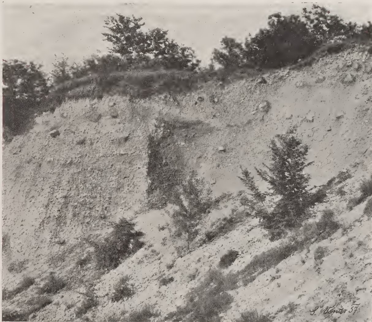
Fig. 11. — La più meridionale cava di Bissinica, (ovest del Dosso Rossini), con fronte sui 12 metri di altezza: dal basso, 7 metri di ghiaie fresche grossolane, appena cementate, di morenico minuto o fluvio-glaciali; sopra, 3 metri di morenico relativamente fresco, con ciottoloni di gneiss, tonalite, porfido e calcari. Ciottoli anche di m. 1,50 di diametro sono franati sul piano di cava. Al tetto, m. 1,20 di ferretto, sviluppato tutt'attorno.
