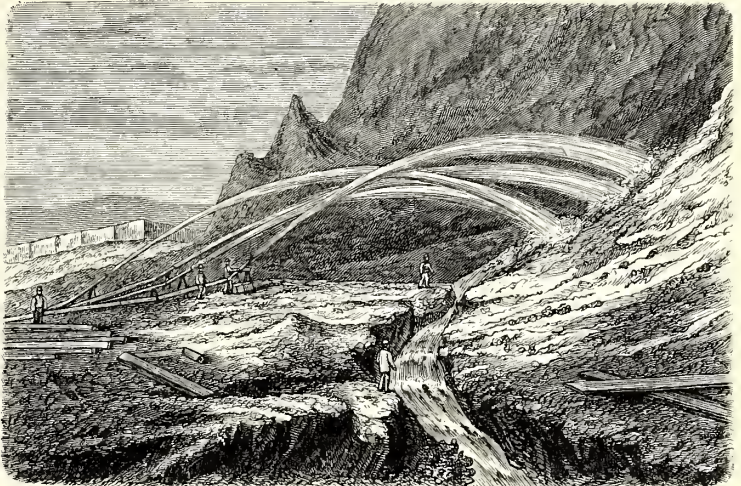
1. Hydraulische Abbaumethode in Kalifornien.
