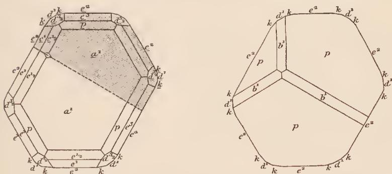
Fig. 4 et 5. — Projection sur la base des deux extrémités d'une macle de tourmaline noire d'Ambatomainy.
