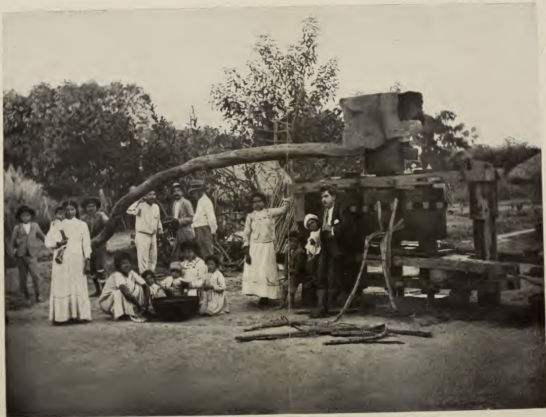
Trapiche, altertümliche Zuckerrohrquetsche aus 3 ungefügigen Holzwalzen im Beni. Links hocken Indianer um einen Kupferkessel, in dem der ausgequetschte Zuckersaft gesiedet wird.
