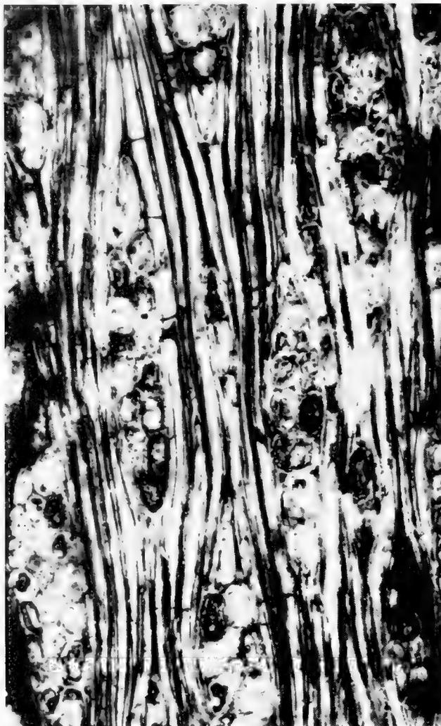
Abb. 6: Tangentialschliff. Heterogene Holzstrahlen mit Kantenzellen und Libriformfasern, teils septiert.
