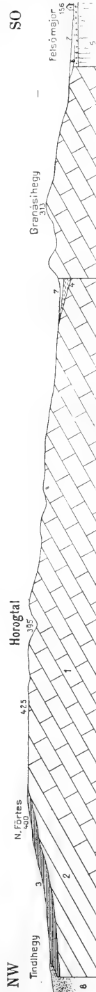
Fig. 8. Profil II, durch die südöstliche Doppelscholle des Vértés von Felső-Major über den Granásihegy und den Tindlberg gegen die Ebene von Ondód.
