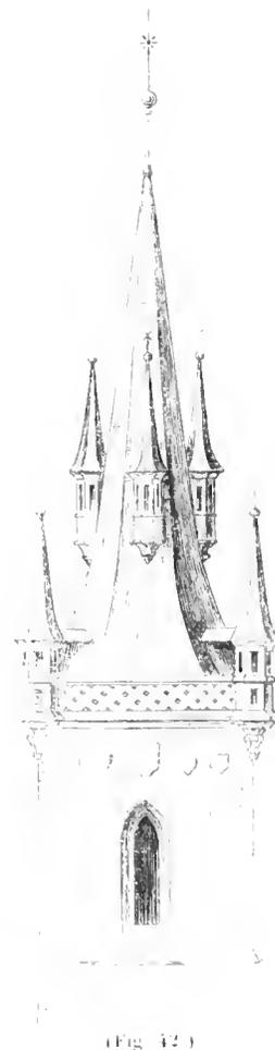
halle mit der Empore und unterstützen die beiden Thürme. Diese sind von quadratischer Grundform, steigen senkrecht auf bis zur Giebelhöhe des Mittelschiffes, wo die Mauern mit einer Gallerie abschliessen und die achteckigen Helme ohne sonstige Vermittelung beginnen. Die Helme sind von ausgezeichnet schöner Form und mit einem doppelten Kranze kleiner Thürmchen umgeben (Fig. 42). Die Helme der Teynkirche wurden wiederholt nachgedacht, z. B. in Pardubitz und an der Stephanskirche in Prag.
