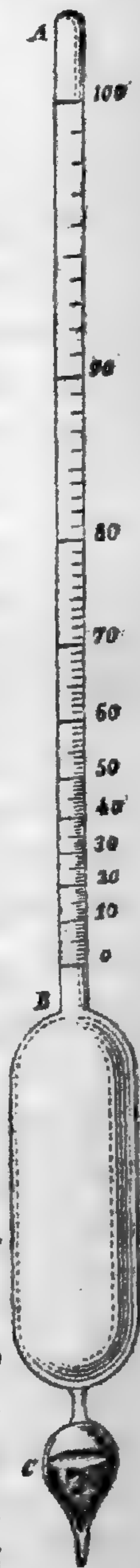
Fig. 21 Alcohómetro centesimal de Gay-Lussac.
