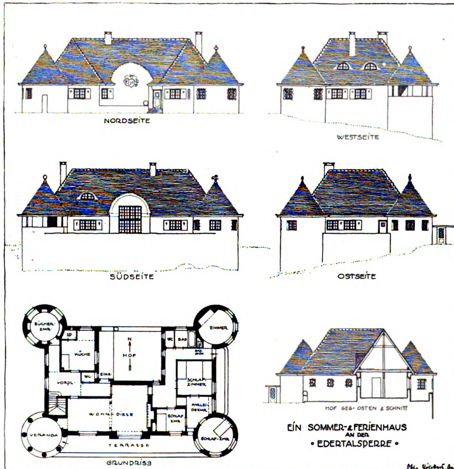
Otto Völckers, München Entwurf zu einem Ferienhaus an der Edertalsperre Oben: Schaubild von Nordwesten. — Unten: Grundriß, Aufrisse und Schnitt; Maßstab 1:400
