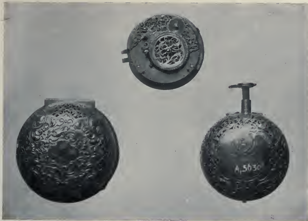
Abb. 1. Taschenspindeluhr in reichem, vergoldetem Gehäuse; Werk mit silbernem Klobeneinsatz von Johann Henner
