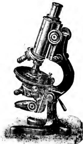
come da figura, composti di: Stativo munito di apparato Abbe, con diaframma ad iride; revolver triplo; tre obbiettivi: 3 e 7\* a secco,  $\frac{1}{12}$ " ad immersione omogenea; tre oculari: 2, 3 e 4; in elegante armadietto lucidato.
