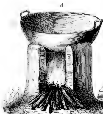
Bassine en fonte de 70 centimètres de diamètre et de 20 centimètres de profondeur; elle est scellée sur un four-neu en maçonnerie et sert à chauffer les feuilles.
