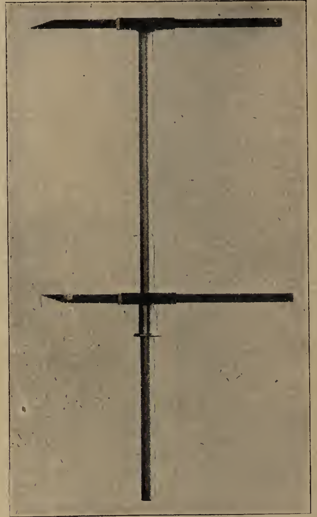
Abb. 2. Stangen-zirkel. Oberstes Teilstück des Anthropometers mit eingestecktem Schieberlineal. \frac{1}{5} nat. Gr. (Aus Martins Lehrbuch, Fig. 31, S. 115.)
