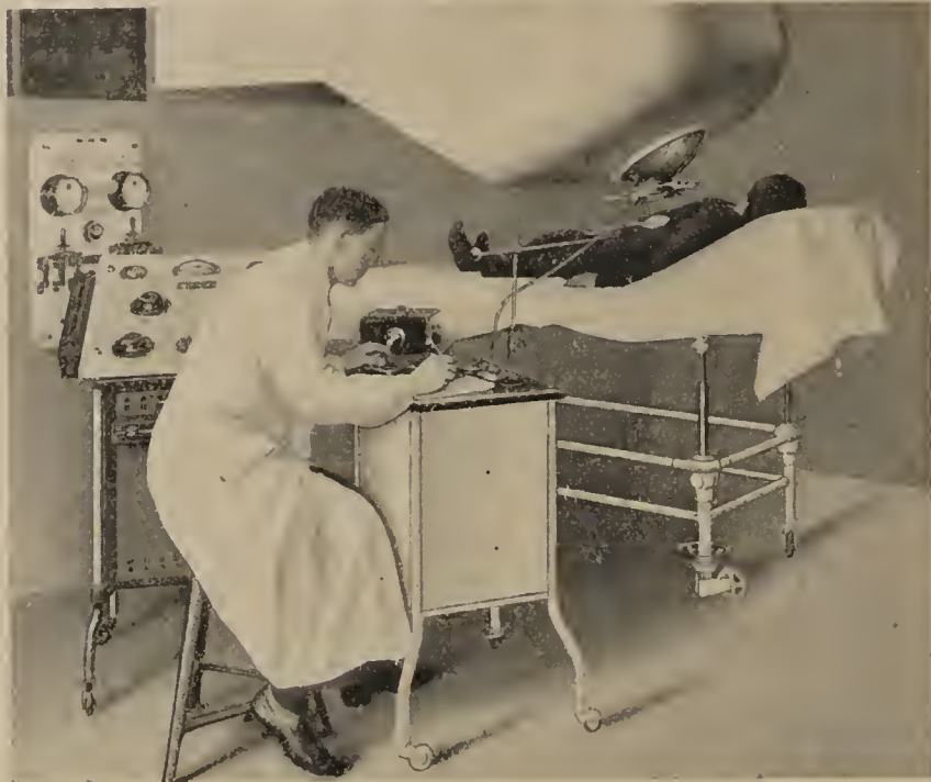
Abb. 9. Messung der Oberflächendosis im Betriebe mit dem Siemens-Röntgen-Dosismesser.
