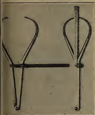
3. Tasterzirkel, geöffnet u. geschlossen. (1/6 nat. Grösse.)
