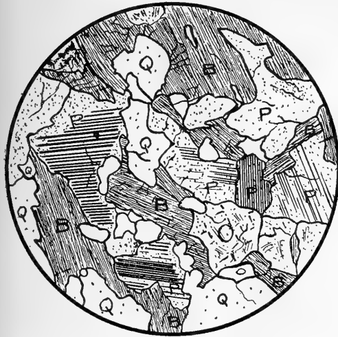
Fig. 5 Sketch of a micaceous gneiss. Actual size 3 mm. Q, quartz; O, orthoclase; P, plagioclase; B, biotite
