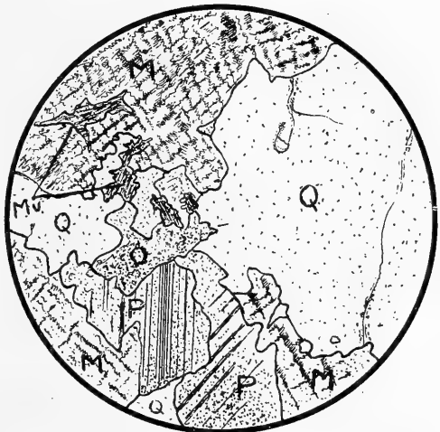
Fig. 6 Shenandoah mountain granite. Actual size 3 mm. Q, quartz; O, orthoclase; P, plagioclase; M, microcline; Mu, muscovite
