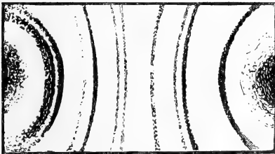
Fig. 23. Röntgenogrammetrisches Verfahren nach P. DEBYE und P. SCHERRER.
