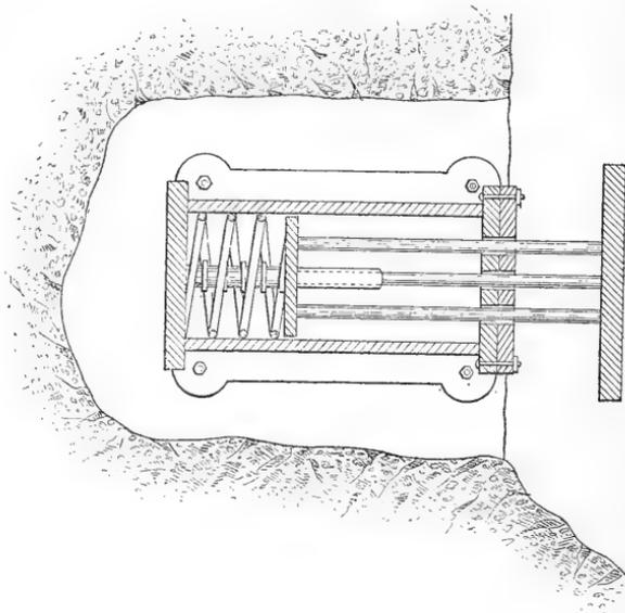
appareils, l'un à la surface, le second à 12 m en avant vers la haute mer et à quelques pieds de profondeur, on a observé que la pression indiquée par ce dernier n'était que la moitié de celle enregistrée par le premier.
