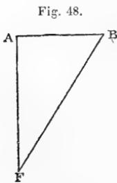
tion dans toute la tranche  $H$ ; on abandonne en même temps du point  $A$  un premier flotteur et un second du point  $F$ . Il est évident que, dans ce cas, le second flotteur viendra choquer le premier, en apparaissant à la surface à une distance  $AB$  de  $A$  dépendant de la profondeur, de la rapidité du courant et de la légèreté du flotteur qui le fait remonter plus ou moins rapidement, et qu'il sera aisé de déterminer en observant son azimut et en mesurant,
