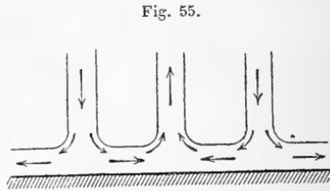
Deux courants qui arrivent parallèlement entre eux (*fig. 55*) et perpendiculairement sur une côte droite donnent naissance à un double système de deux courants divergents longeant le rivage et à un courant de réaction s'éloignant de la côte dans une direction perpendiculaire, vers la haute mer.
