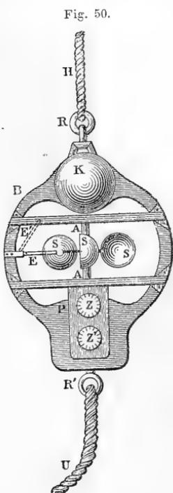
courant superficiel ou profond, mais il n'en donne pas la direction. Une croix<sup>1</sup>, dont chacune des quatre branches S, S, S, est terminée par une demi-boule creuse, tourne autour de l'axe A, communique avec un double compteur de tours ZZ' et est fixée au milieu d'une monture en métal B. En K est une sphère très lourde; R et R' sont deux anneaux où sont attachées deux cordes indépendantes l'une de l'autre.
