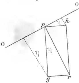
On sait que la surface de niveau est celle perpendiculaire à la direction du fil à plomb. Or, dans l'hémisphère nord, une molécule  $p$  soumise (fig. 59) à l'action de la pesanteur  $pg$ , sera déviée vers sa droite, de  $ph$ , par la rotation terrestre et suivra par conséquent la résultante  $pr$  à laquelle la surface actuelle des eaux  $Opo$  sera perpendiculaire. Cette surface
