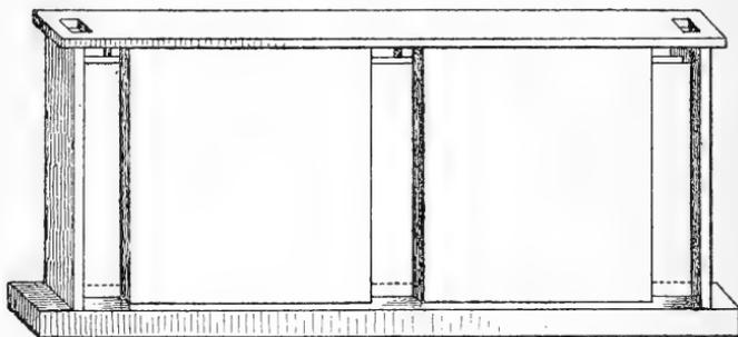
leur partie supérieure par une pièce horizontale percée de deux ouvertures, de sorte que l'on n'apercevait que le milieu et les deux extrémités des glaces mesurant 1,60 m sur 0,80 m. L'appareil était ainsi beaucoup plus solide.
