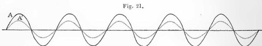
Ainsi l'interférence de deux ondulations A et A' (*fig. 21*) ayant même longueur, même hauteur et se propageant dans la même direction ou dans une direction diamétralement opposée sera figurée par la courbe pleine, de hauteur double, mais de même longueur d'ondulation.
