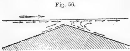
le phénomène était compliqué par la différence de densité entre l'eau douce du fleuve et l'eau salée. On les reproduit artificiellement dans l'auge en envoyant un courant d'air constant au-dessus d'un seuil artificiel formé par une lame de plomb (fig. 56), ou au moyen d'un courant d'air divergent (fig. 57). Humboldt<sup>1</sup> en a reconnu au-dessus
