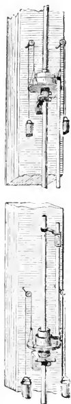
Fig. 5. — Vue en perspective du mode de suspension destiné à empêcher les tubes inférieurs d'être comprimés par les tubes supérieurs.
