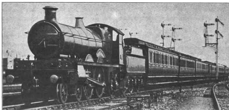
Abb. 12. 2. B. 1-Schnellzug-Lokomotive mit dem Schnellzuge London-Bristol-Ilfracombe.
