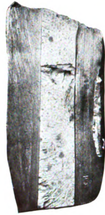
Abb. 5. Großgefüge der Schienenproben aus vier Kopfschienen.
