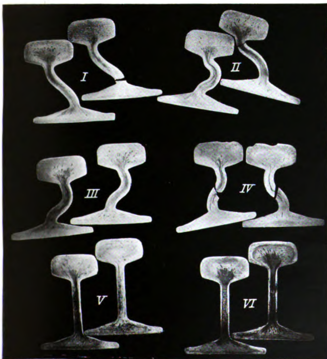
Abb. 6. Untersuchung des Einflusses von Seigerungen auf Biege- und Härtingsprüfungen.
