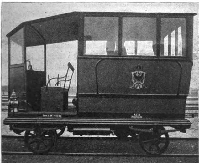
Abb. 3. Triebkleinwagen mit 14 PS-Triebmaschine und geschlossenem Abteile.
