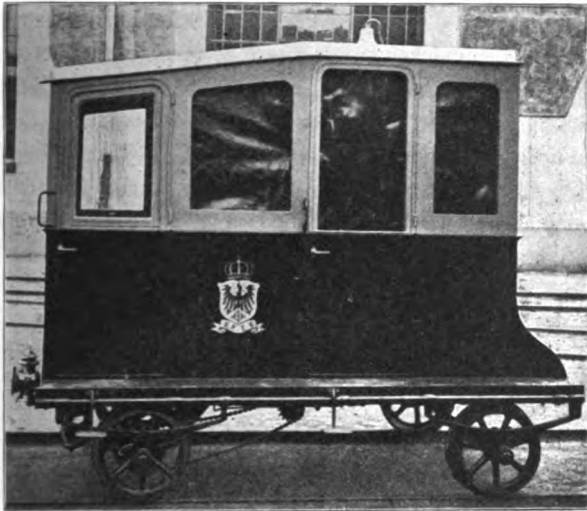
Abb. 2. Triebkleinwagen mit 7 PS-Triebmaschine und Umbau.
