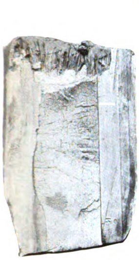
Abb. 1 bis 4. Längsschnitte der aus dem Kopfe des Blockes stammenden vorgewalzten und abgeschnittenen Blockenden.
