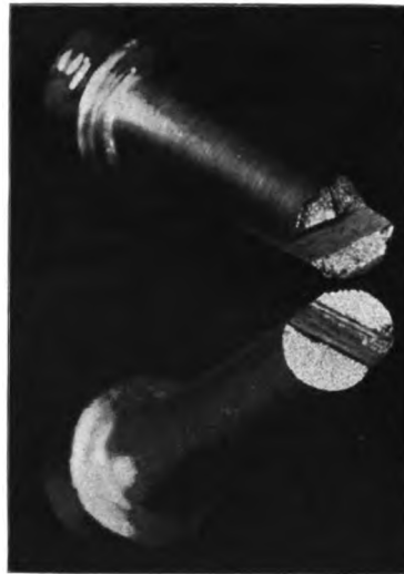
Abb. 11. Großgefüge einer mit klarem Lunker behafteten Schiene.
