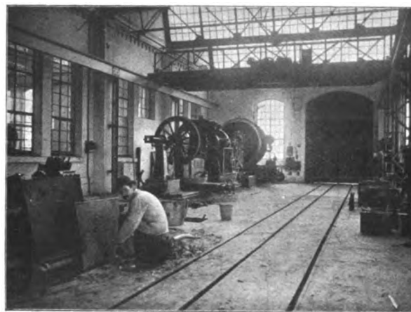
Abb. 14. Neue Dreherei. Schleifmaschinen für Achsschenkel, äußere und innere Kurbelzapfen.
