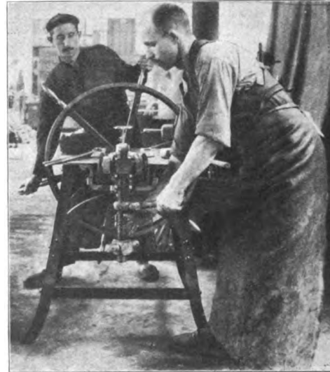
Abb. 3. Bügelbiege- und Richt-Maschine von Engelbrecht, zweiter Arbeitsgang.
