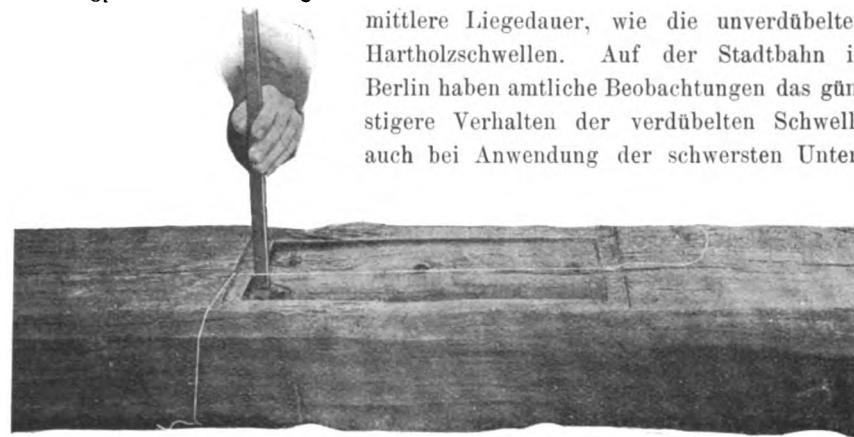
Abb. 5. Verdübelte Kiefernswelle. Unterlegplatte 4 mm tief eingedrückt.
