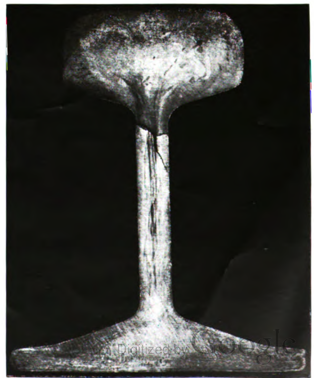
Abb. 7. Untersuchung des Einflusses von Seigerungen auf Ribbildung bei Härtingsprüfungen.
