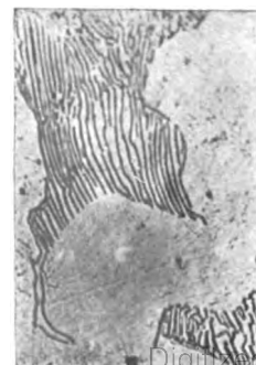
Abb. 25. Unterwohlgeordneter Stahl, Perlit und Ferrit. — 500-fach.
