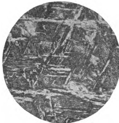
Abb. 13. Austenit, Chromnickelstahl überhitzt gehärtet, aus sehr hoher Wärme schroff abgeschreckt — 150-fach.
