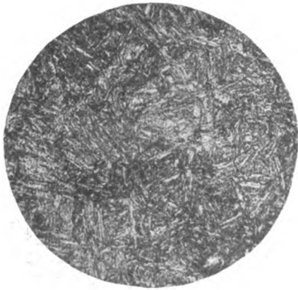
Abb. 18. Sehniger Bruch einer eingekerbten Biegeprobe.
