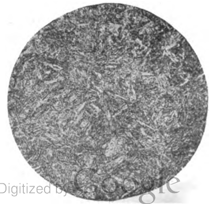
Abb. 14. Martensit bei Abkühlung über 700°, entsprechend dem Umwandelungspunkte Ar 1 , weiß, feste Lösung bis 1,5% C-Gehalt v. Zementit in \gamma =Eisen. — 150-fach.
