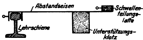
Abb. 8. Abstandseisen bei Gleisverschwenkungen.
