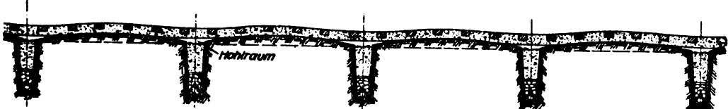
c) der gleiche Längsschnitt bei kräftigem Auffrieren.
