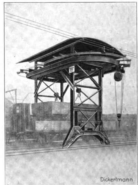
Abb. 1. Auf- und Abladen eines beschädigten Wagens.
