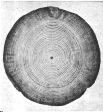
Abb. 2a. Nach dem Kyanverfahren getränkte Kiefer.
