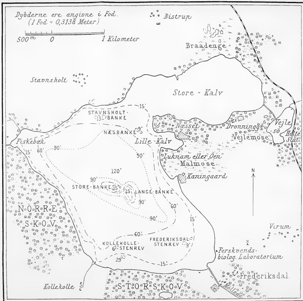
Carte du Furesø et du pays environnant. Dans les indications de profondeur, le pied a été choisi pour unité de mesure. Le levé du fond du lac et l'exécution de la carte sont dus à M. l'ingénieur O. WOLFF qui a bien voulu les mettre à notre disposition pour la présente étude. Nous le prions d'agréer ici nos remerciements respectueux.
